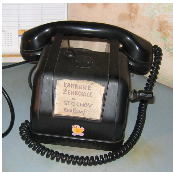
Telefonní přístroj MB pro hláskové spojení s tlačítkem s evidencí obsluhy pro nouzové udělení telefonické odhlášky
