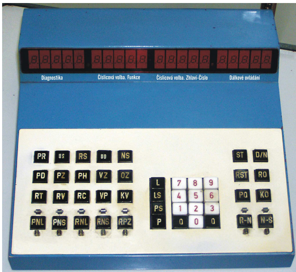
Ovládací skříňka RZZ cestového systému s číslicovou volbou a displejem
