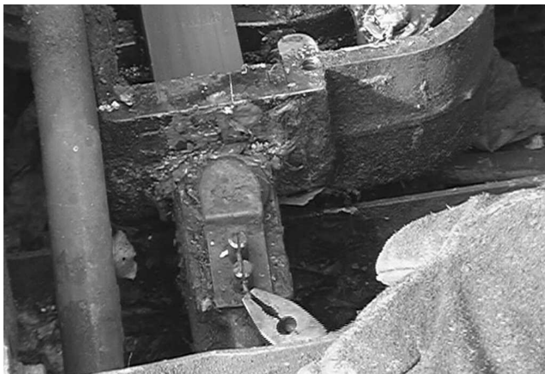
Sejmutí plomby na drátu a vytažení závlačky
