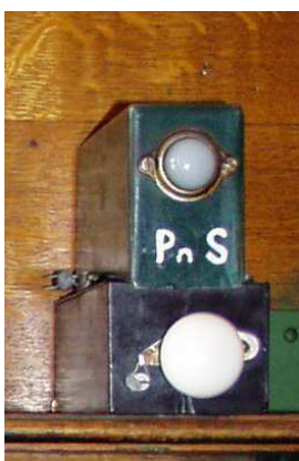
Tlačítko pro obsluhu PN s evidencí obsluhy na řídícím přístroji
