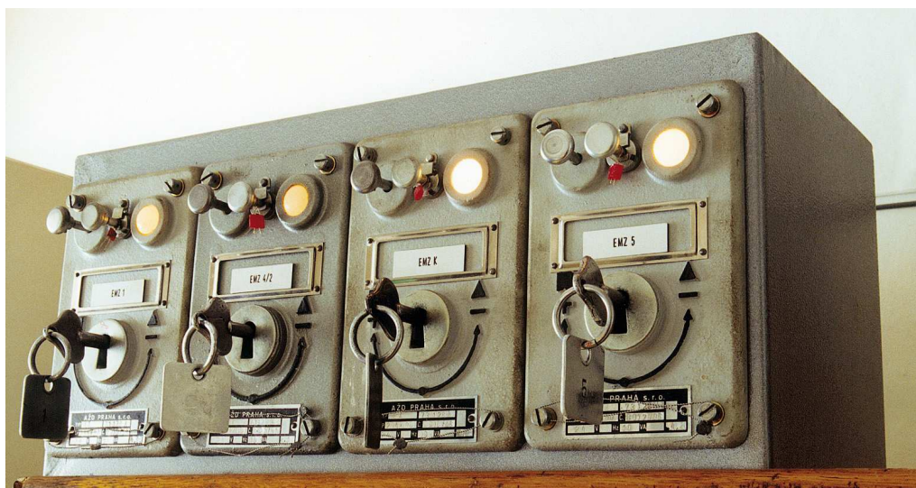
Elektromagnetické zámky pro vnitřní použití
