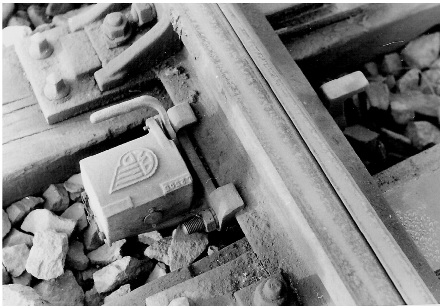
Uzamčený výměnový zámek bez ochranné skříňky
