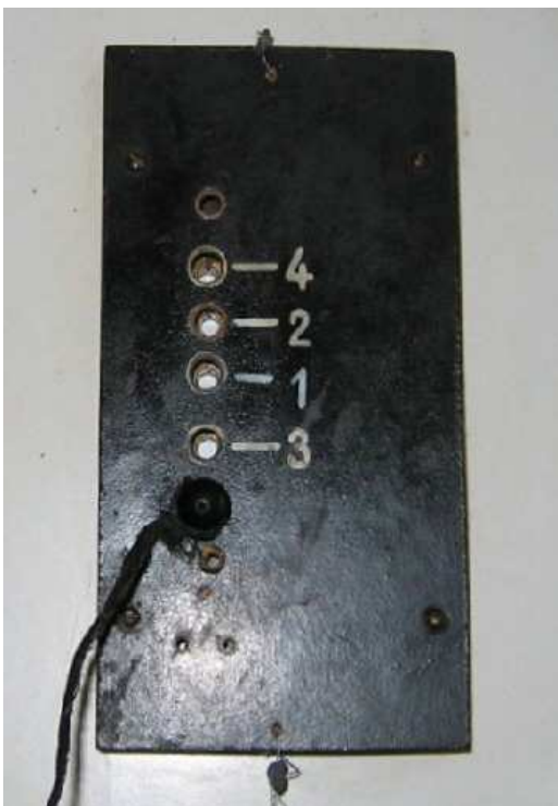
Kolíčkový zapojovač – vertikální provedení
