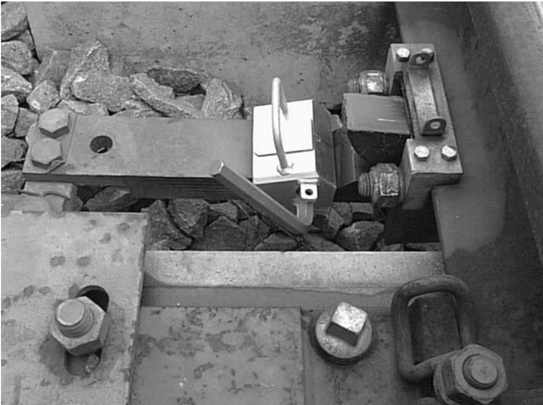
Přenosný zámek čelistového závěru
