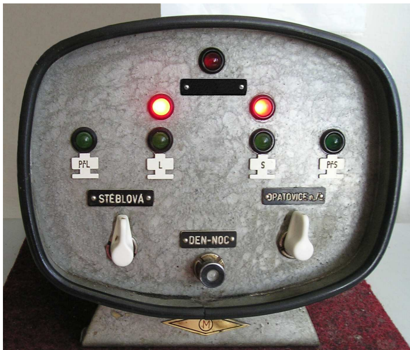
Příklad rozmístění indikačních a ovládacích prvků na hlásce
