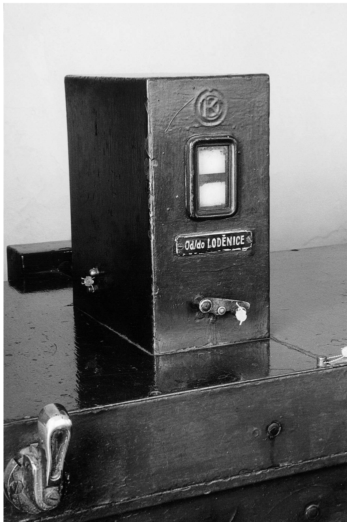
Samočinný závěr výměn s jedním okénkem rozděleným na dvě poloviny
