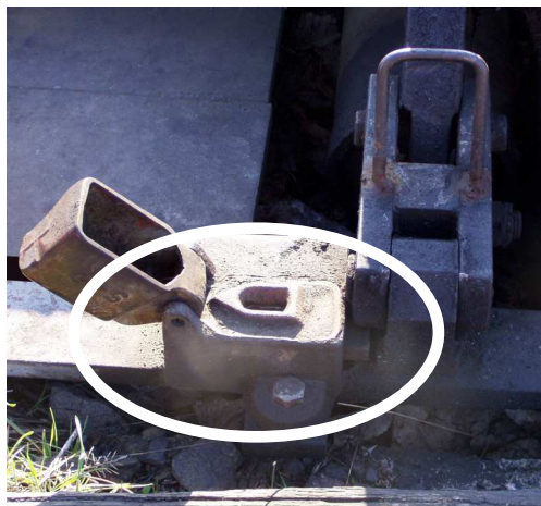
Samovratný přestavník (zapnutý do samovratné činnosti)
